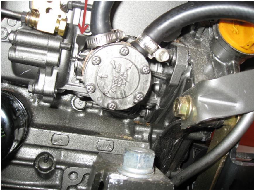
4. Entlüftungsschraube verschließen. **ACHTUNG die Schraube bitte mit Gefühl anziehen. Das Gewinde wird sonst beschädigt.**
