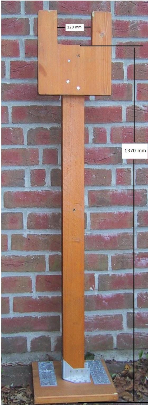
**Wichtig:** Die Stütze muss durch zwei Leinen zu den Heckklampen gegen Umfallen gesichert werden
